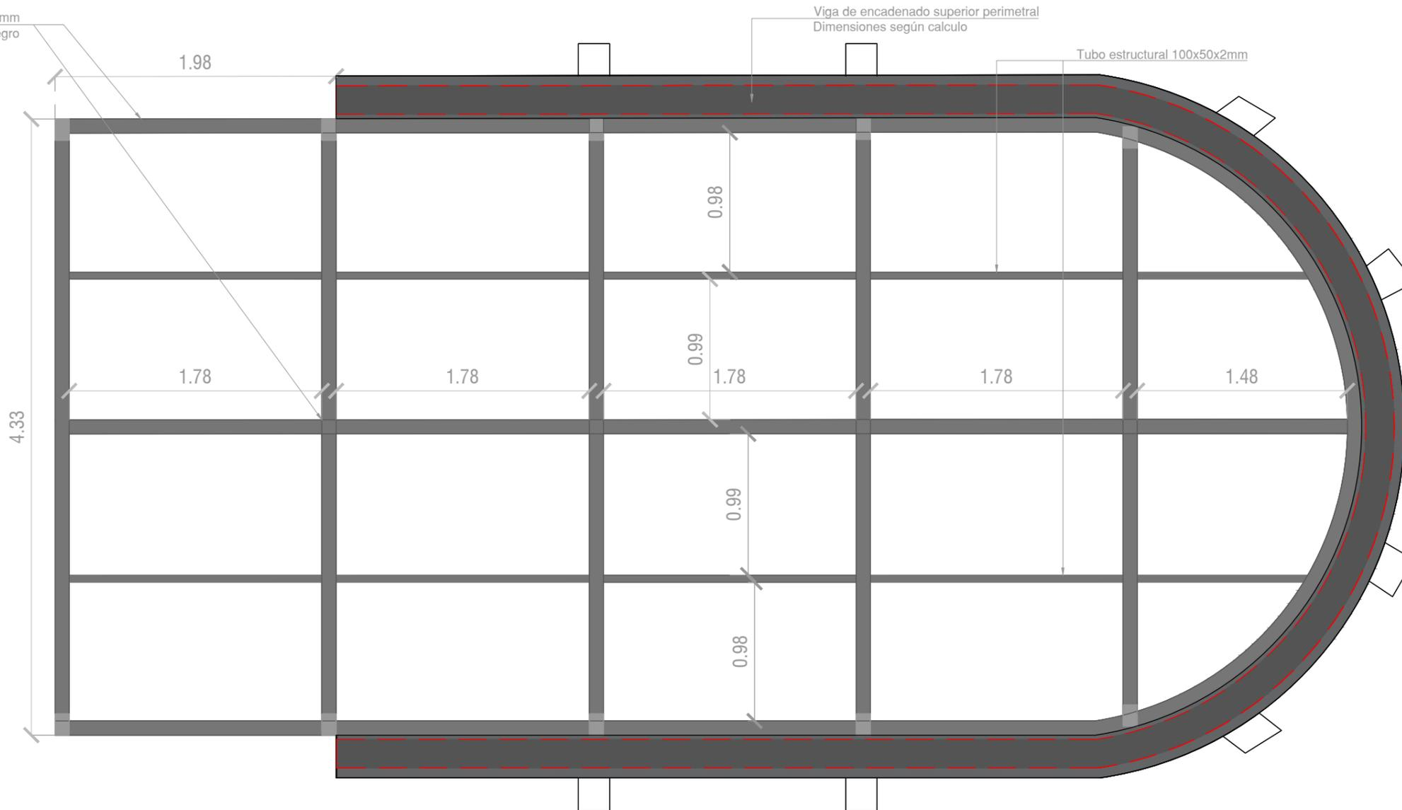
PLANTA DE TECHO- ESTRUCTURA
