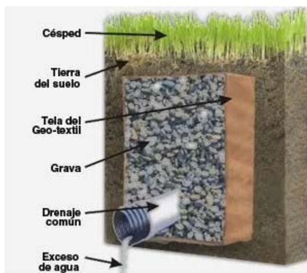
Figura 44. Zanjas filtrantes vegetadas
