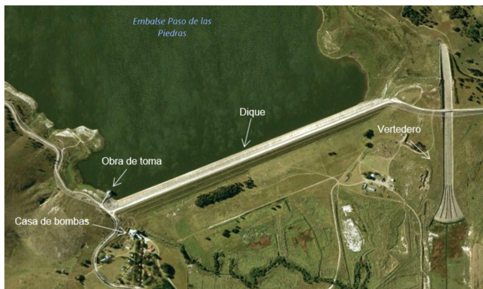
Figura 3: Imagen Satelital – Ubicación Obras Principales
