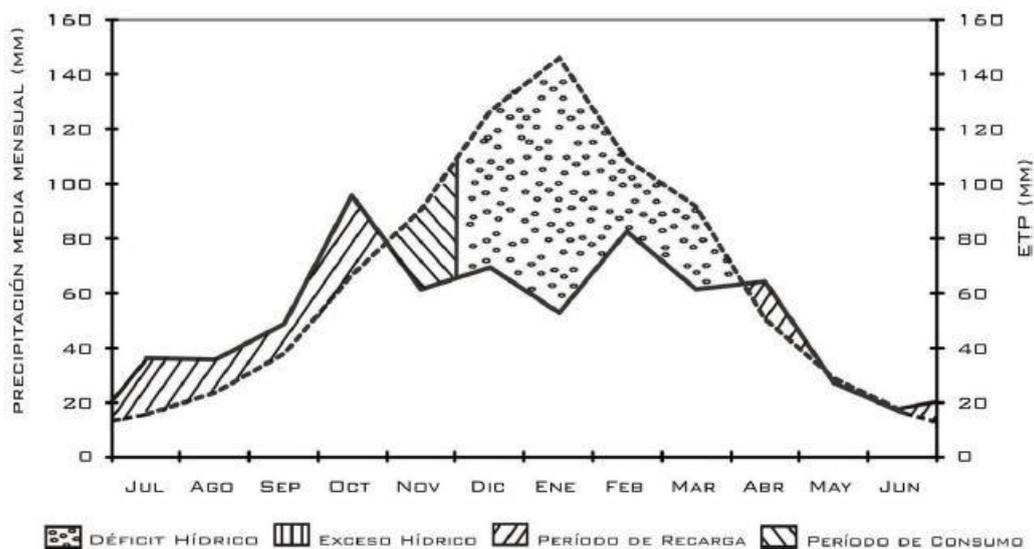
**Figura 37: Balance Hídrico según datos de la Est. Bahía Blanca Aero (2001-2010)**
