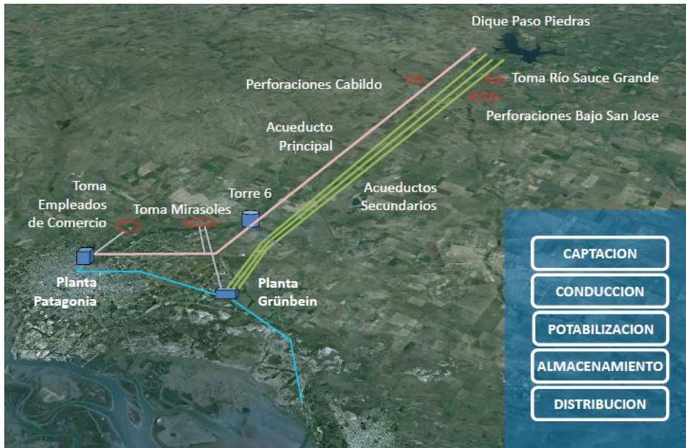
**Figura 3: Esquema captación de agua Bahía Blanca**
