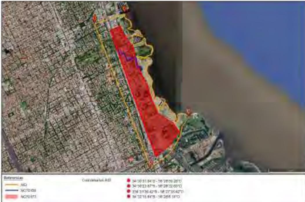
El objetivo del Proyecto RPC<sup>1</sup> Nuevo Colector Yrigoyen, es transferir el caudal de la EBC<sup>2</sup> Yrigoyen y parte del radio servido al colector existente Paseo de la Costa Urbanización U11 –1° Etapa de DN700 mm, desafectando la Estación de Bombeo.
