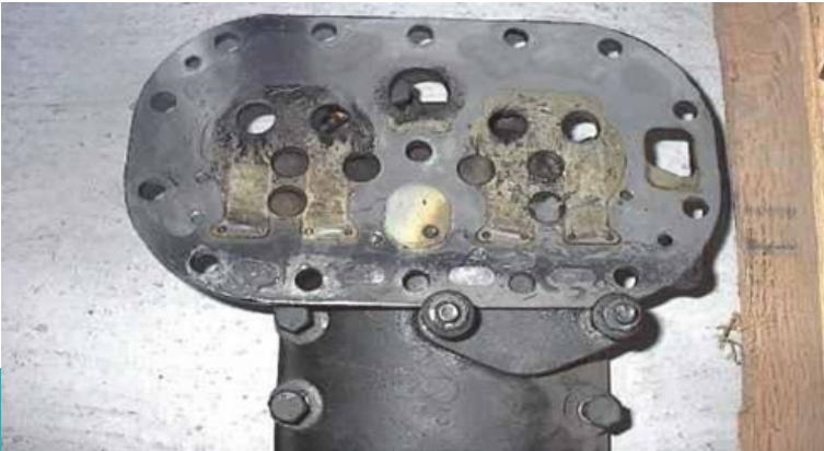
Plato de válvulas con un sobrecalentamiento
