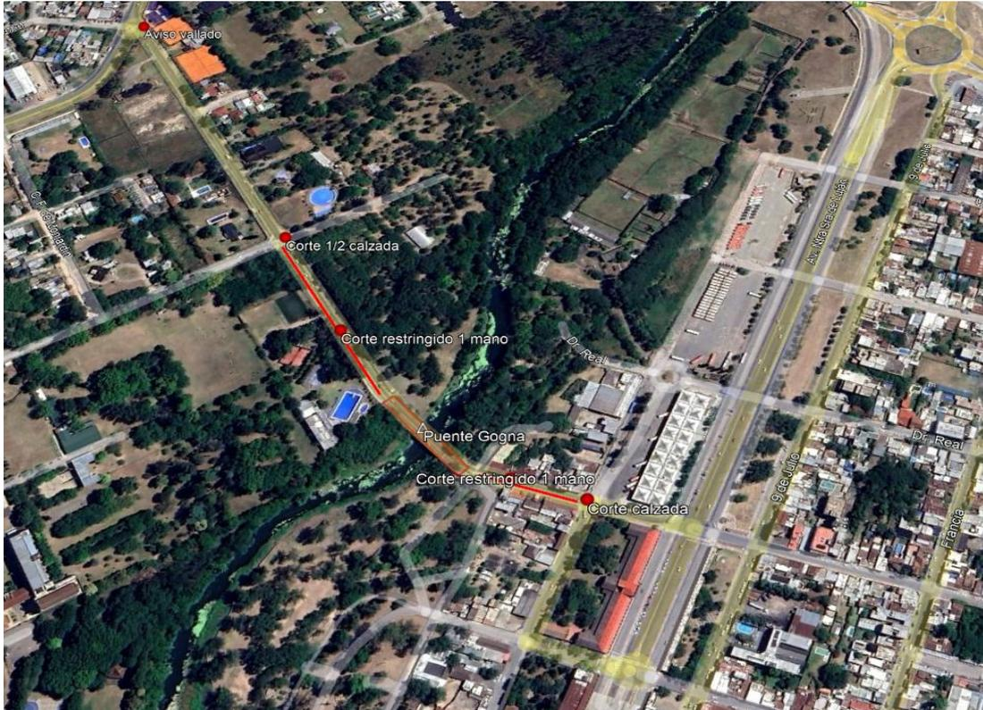
Figura 6 Esquema de corte y señalización durante la obra.
