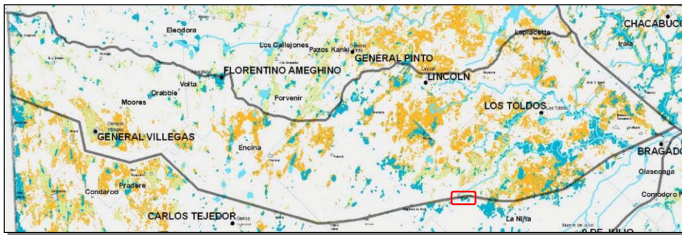
Figura 20: Mapa de inundaciones considerando las obras propuestas, modeladas para 2 (azul), 5 (verde) y 10 (anaranjado) años de recurrencia. El recuadro rojo indica la ubicación del Proyecto.
