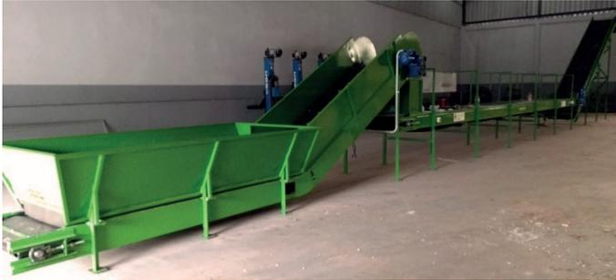
Figura 26: Cinta de clasificación de piso en Nodo.
