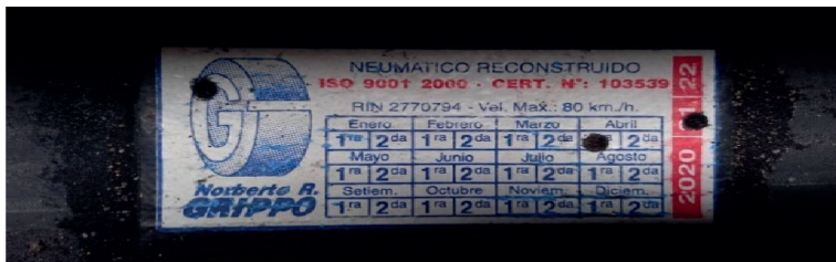
Etiqueta interna para la trazabilidad de la reconstrucción
