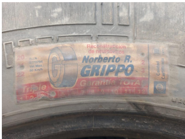
16. Colocación de etiquetas identificatorias por fuera y por dentro del neumático, indicando fecha, lugar y número de recapado.
