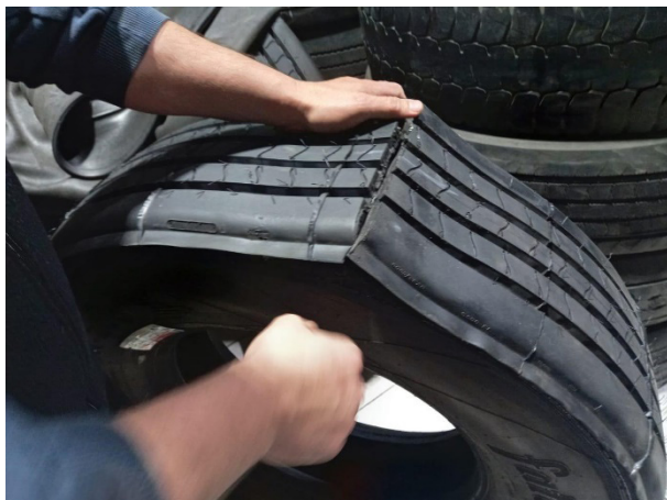
15. Inspección final. Por ejemplo, en este caso falló la vulcanización por una descompresión del neumático dentro del autoclave.
