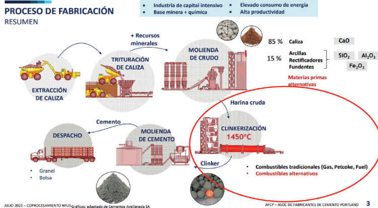
Figura A1F2 Proceso de fabricación de cemento
