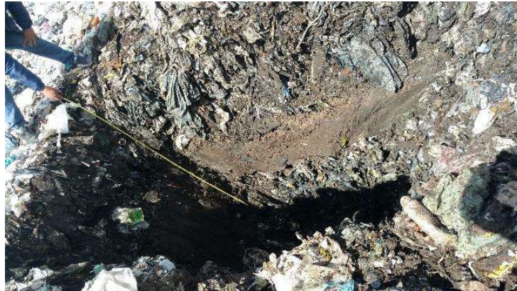
Foto 5. Calicata profunda donde se observan aproximadamente 2 m de residuos sobre suelos modificados.
