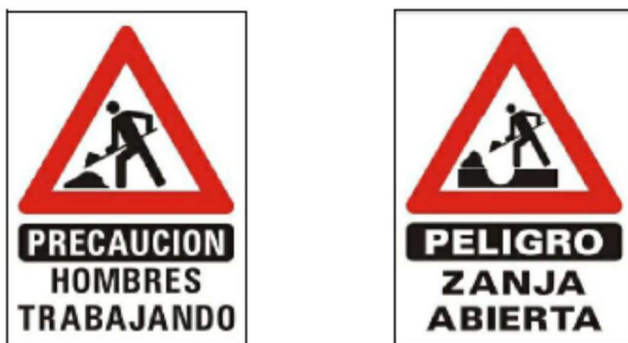
Figura 67. Modelos de cartelería a colocar en la zona de obras, zanjas
