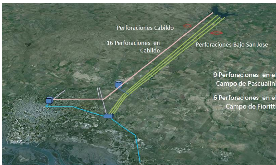
Figura 4: Esquema Sistema de captación subterránea
