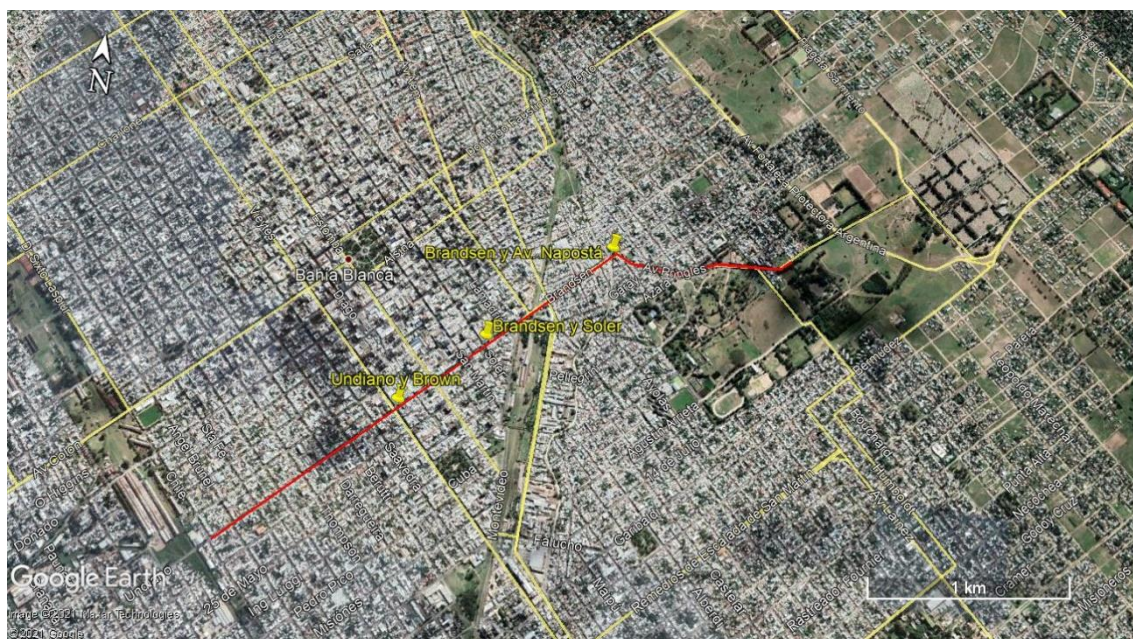
Figura 12. Ubicación geográfica de las válvulas de limpieza
