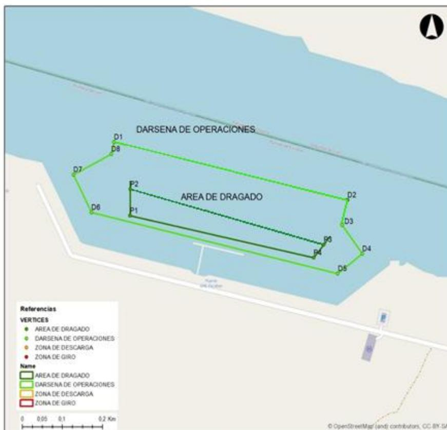
Figura 1. Dragado de Apertura: Área de Dragado dentro de la Dársena de Operaciones de la Terminal de GNL Escobar.
