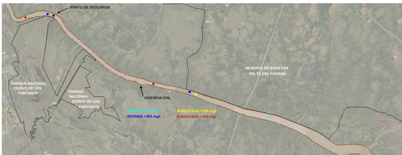
**Figura 38. Esquema de las posiciones máximas, aguas arriba y aguas abajo, que alcanzan las concentraciones mayores a 150 mg/l y a 200 mg/l dentro del cauce del río para las dos condiciones de simulación.**
