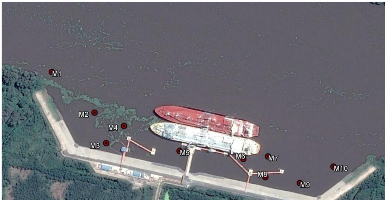
**Figura 63. Ubicación de las muestras de sedimentos del lecho extraídas para posterior análisis granulométrico.**
