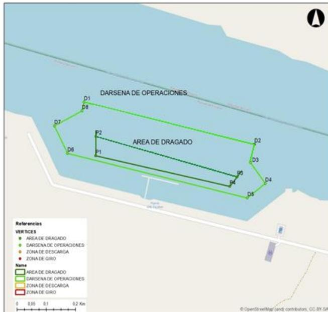
Figura 3. Área de Dragado dentro de la Dársena de Operaciones de la Terminal de GNL Escobar.
