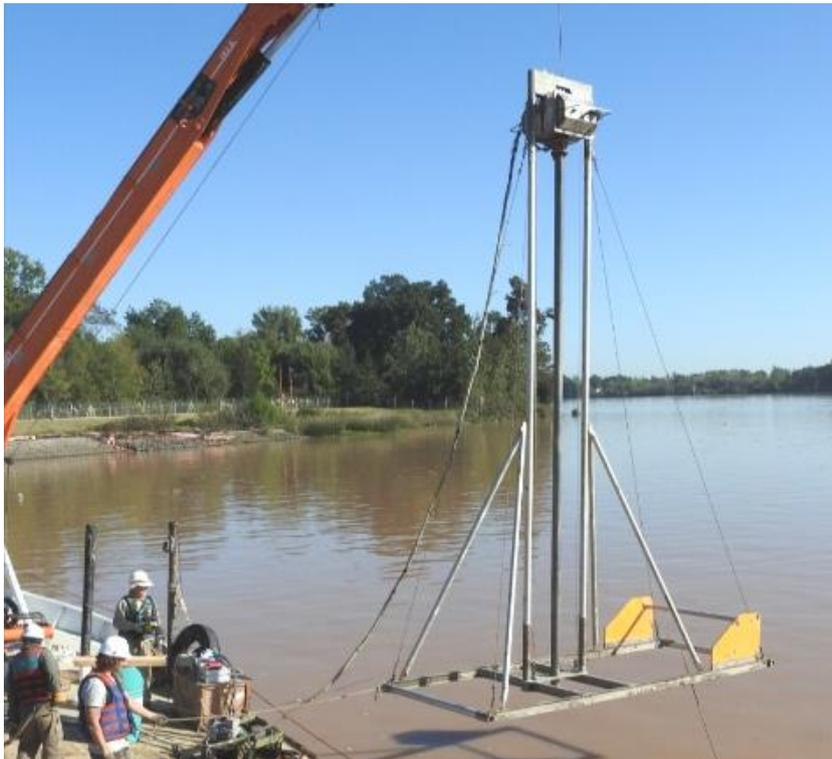
**Figura 55. Descenso del Vibrocorer FISALIA en el punto S1, base alineada con la pendiente del lecho para evitar que el equipo se tumbe.**
