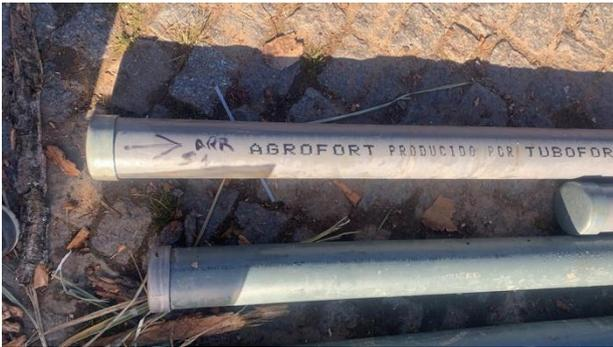
Figura 59. Señalización dirección de la parte superior del testigo recuperado.
