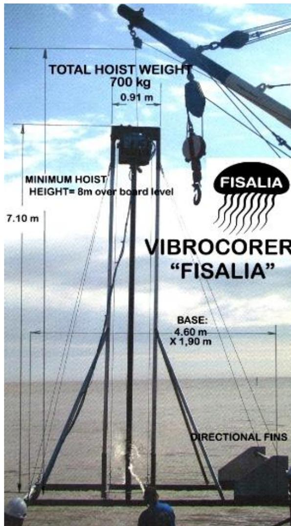
Figura 54. Dimensiones principales Vibrocorer FISALIA.
