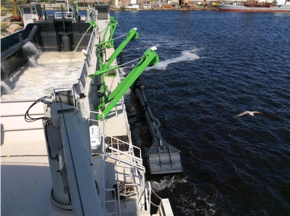
Figura 5. Imagen de una draga de succión por arrastre en operación.
