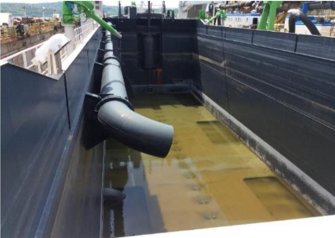
Figura 6. Imagen de la cántara de una draga de succión por arrastre.
