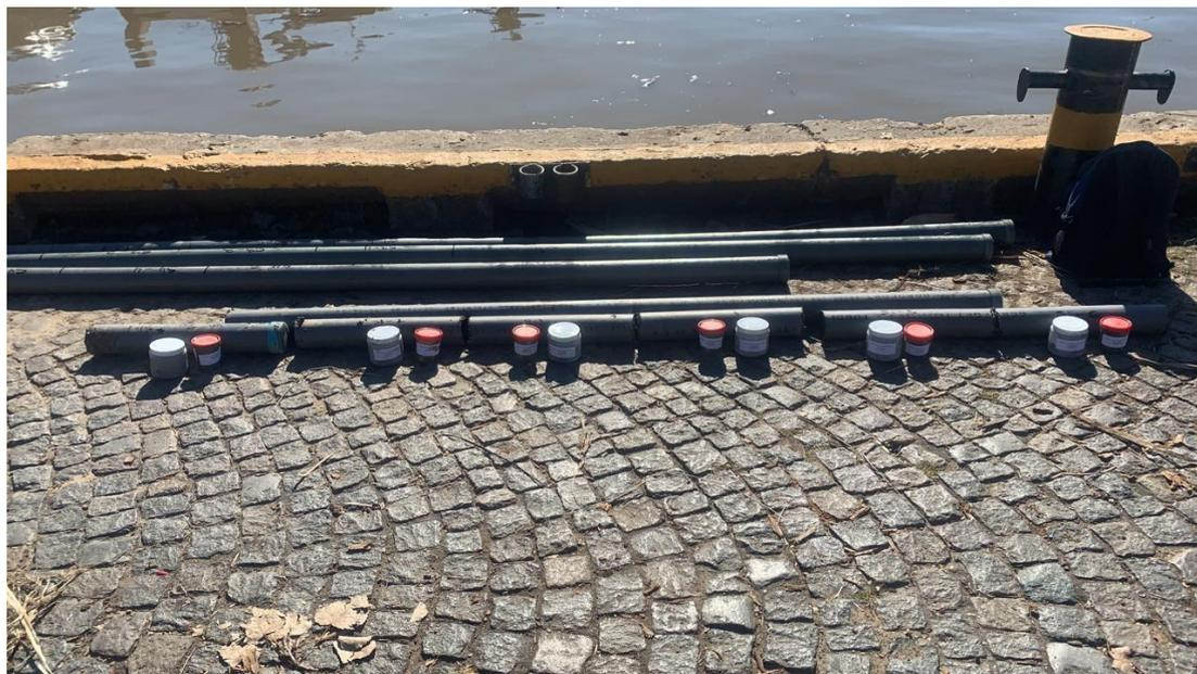
Figura 62. Preparación de las muestras individuales para los testigos S1, S2, S3 y S4.
