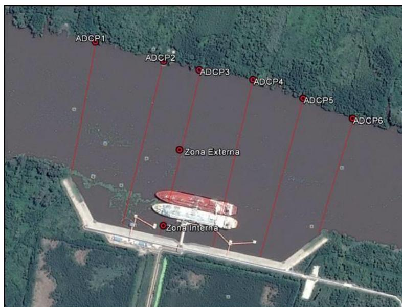
Figura 11. Ubicación de las secciones de medición de velocidad con ADCP.
