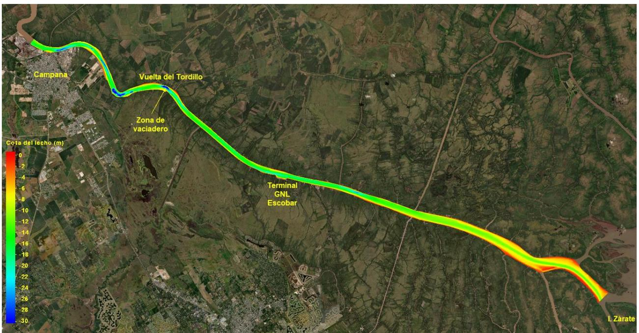
Figura 10. Batimetría del lecho de la malla de elementos finitos del modelo bidimensional MIKE 21 FM.
