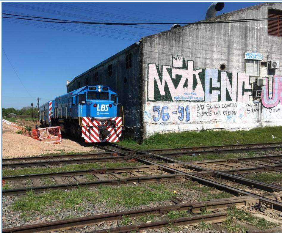
**Fotografía 8.8** Ejemplo Cruce a Nivel de vía simple de trocha angosta con vía doble de trocha ancha.
