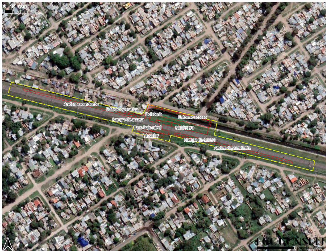
Figura 32 Demarcación de principales puntos de obra y delimitación de área operativa como línea punteada
