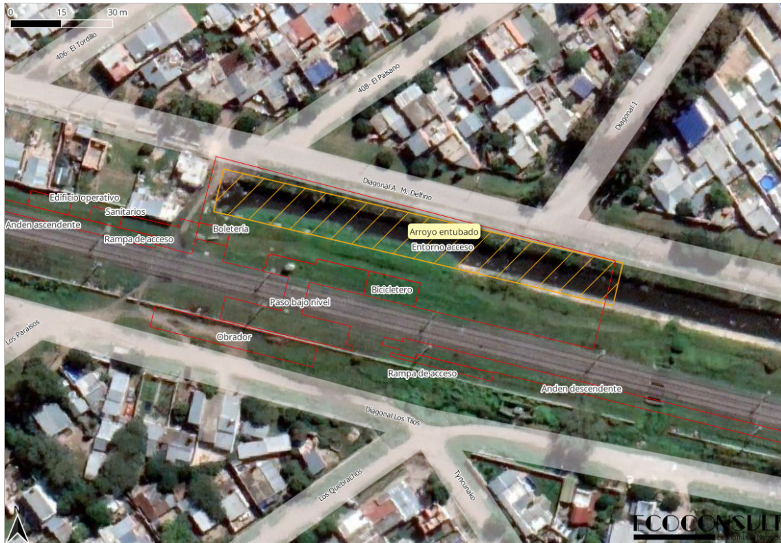
Figura 31 Extensión de tramo entubado en contexto de límites de estructuras del diseño conceptual de la estación
