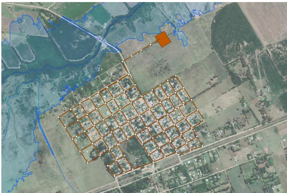
*Figura 2-Ubicación y trazado de la Planta y Red de tratamiento cloacal de la localidad de Olivera*
