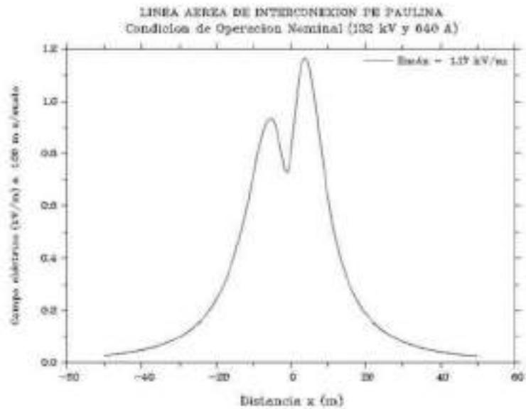
Figura 20: Magnitud del campo eléctrico en función de la distancia.
