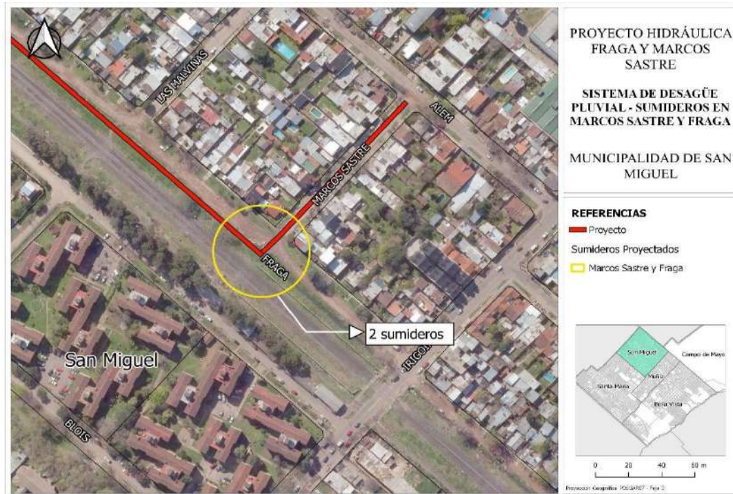
Figura 5.2 Mapa de obras, Sistema de Desagüe Pluvial y Sumideros en Fraga y Marcos Sastre, San Miguel. Elaboración propia.
