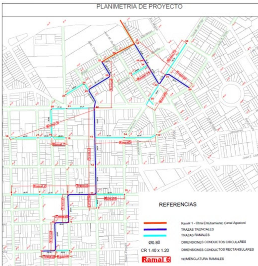
Figura 2 – Traza propuesta de red de desagües pluviales Pilar Centro
