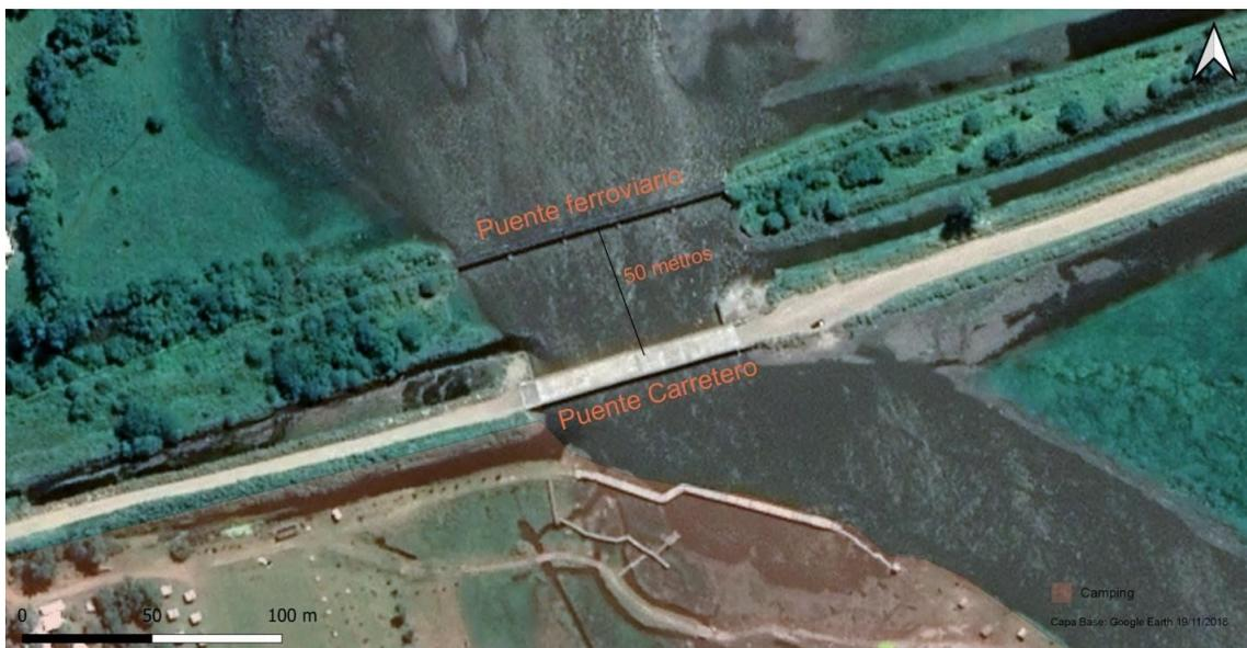
**Figura 9:** Detalle del puente carretero y su cercanía con el ferroviario Fuente: Elaboración propia, Año 2020
