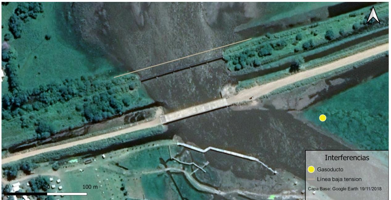
**Figura 12:** Interferencias inmediatamente asociadas al puente (gasoducto y línea de baja tensión).
