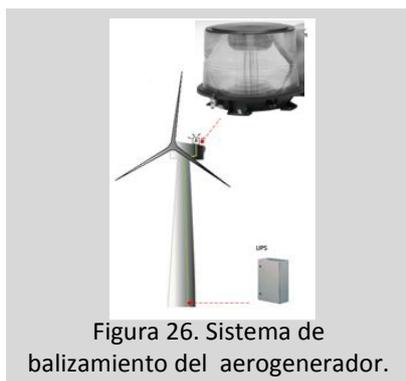
Figura 26. Sistema de balizamiento del aerogenerador.
