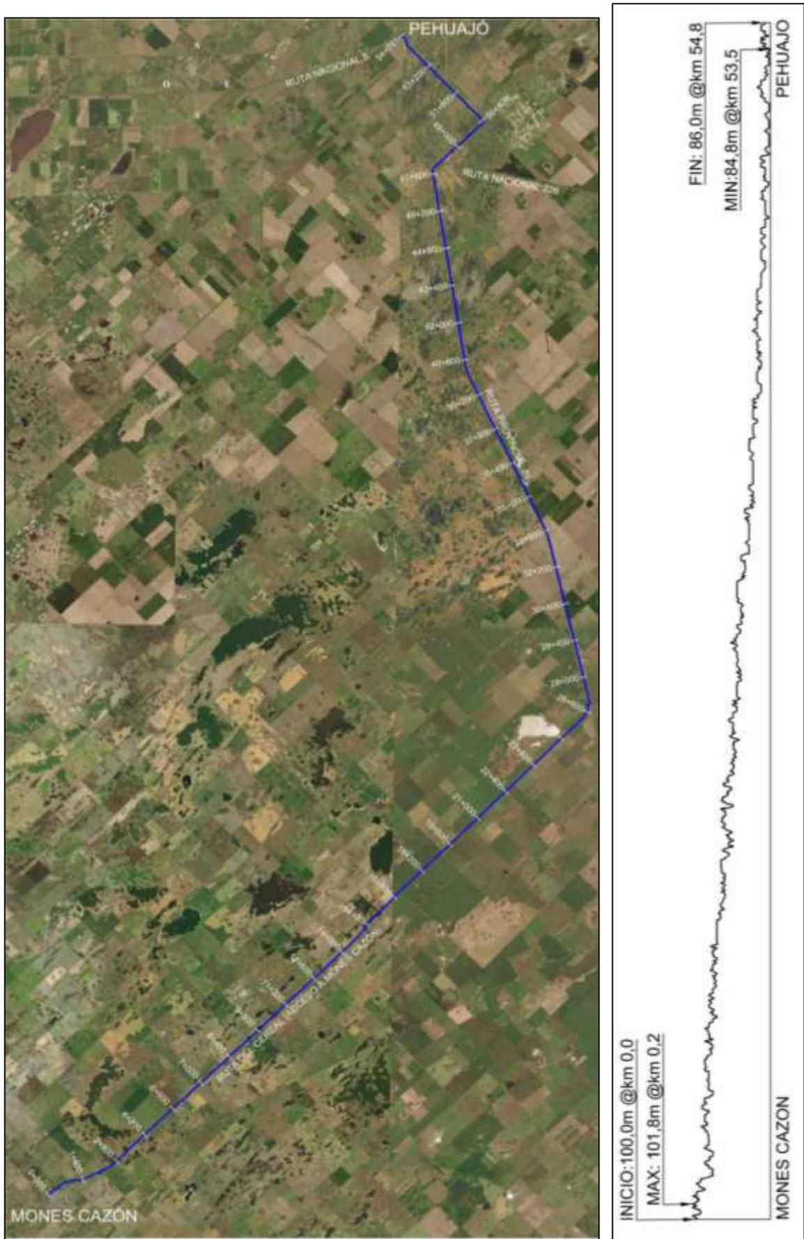
Figura 5 – Traza del acueducto y perfil de elevaciones
