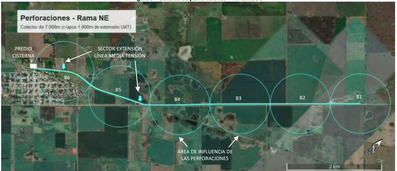
Figura 10 – Sistema de perforaciones – variante NE
