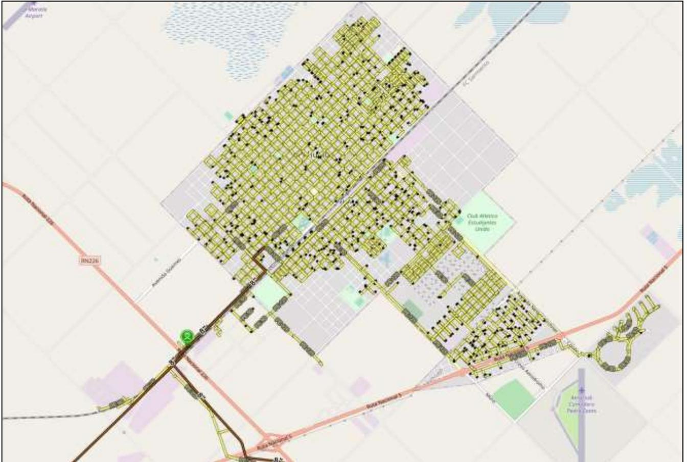
Figura 55 - Gasoducto y planta reductora de presión
