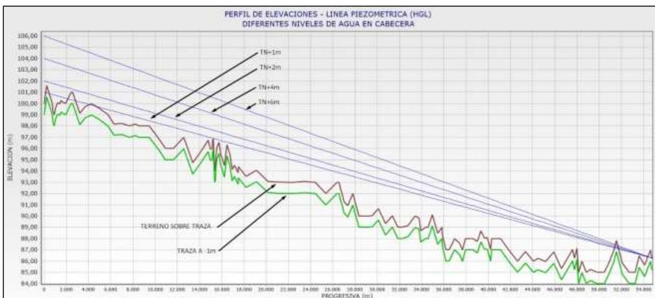
Figura 6 – Comparativa de piezométricas sin bombeo
