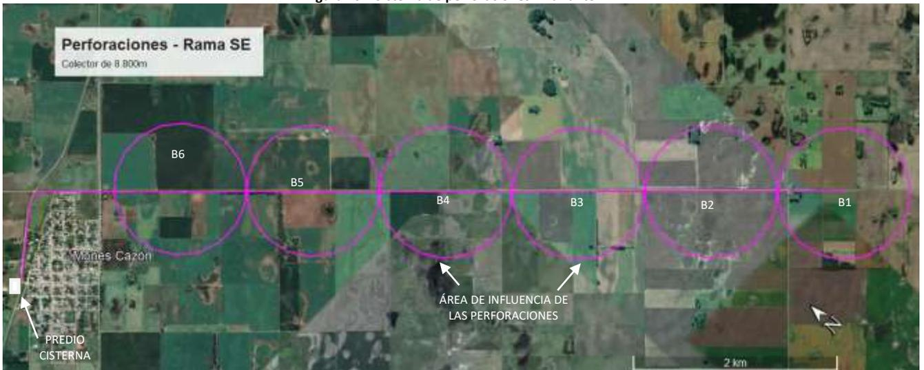
Figura 11 – Sistema de perforaciones – variante SE
