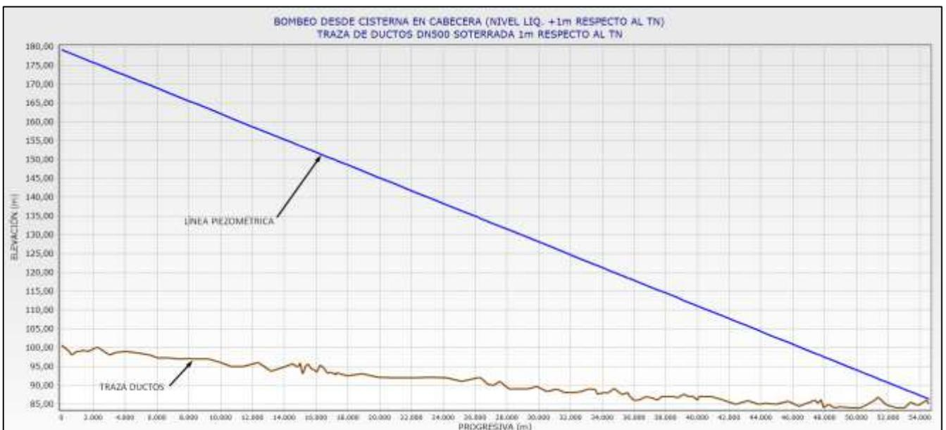
**Figura 8 – Perfil piezométrico con bombeo**
