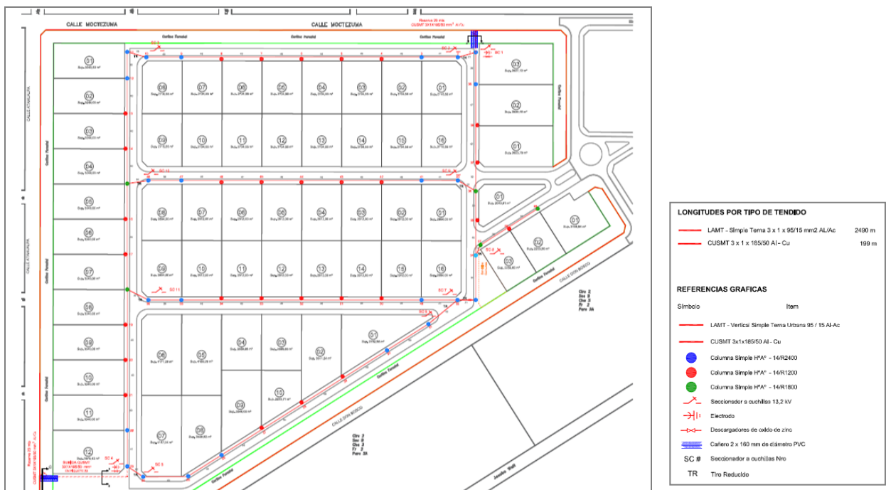
Imagen. Vista de línea aérea de media tensión.
