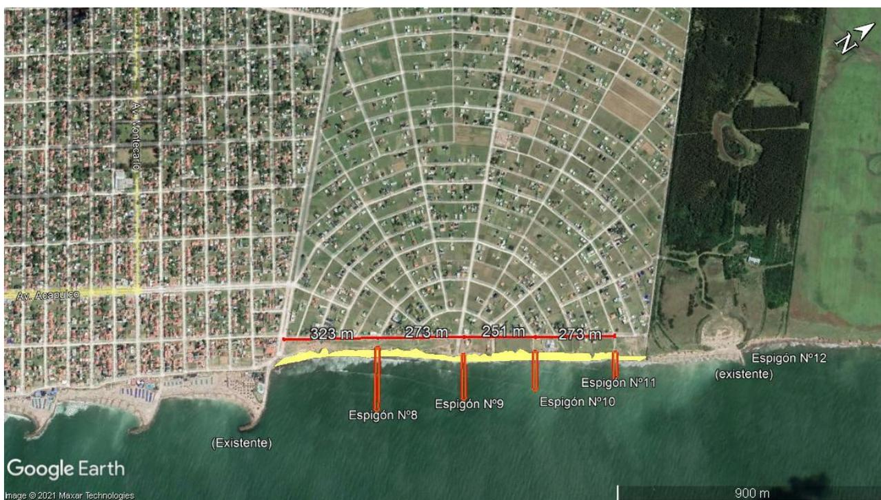
**Figura 6:** Sistema de Espigones de transición y Relleno Artificial de Arena. Elaboración DEA-DPH
