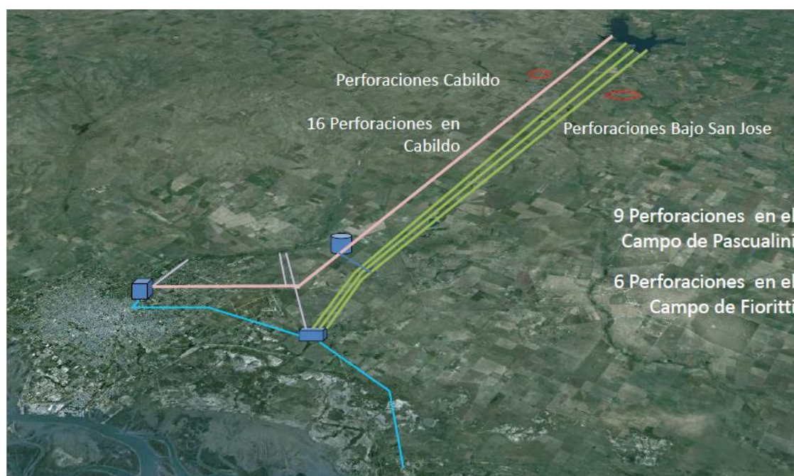
Figura 4: Esquema Sistema de captación subterránea
