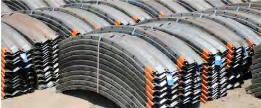
Figura 72: Detalle de dovelas metálicas.
