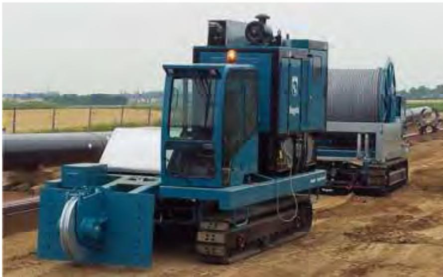
Figura 81: Máquina de tiro para revestimiento por desplazamiento
