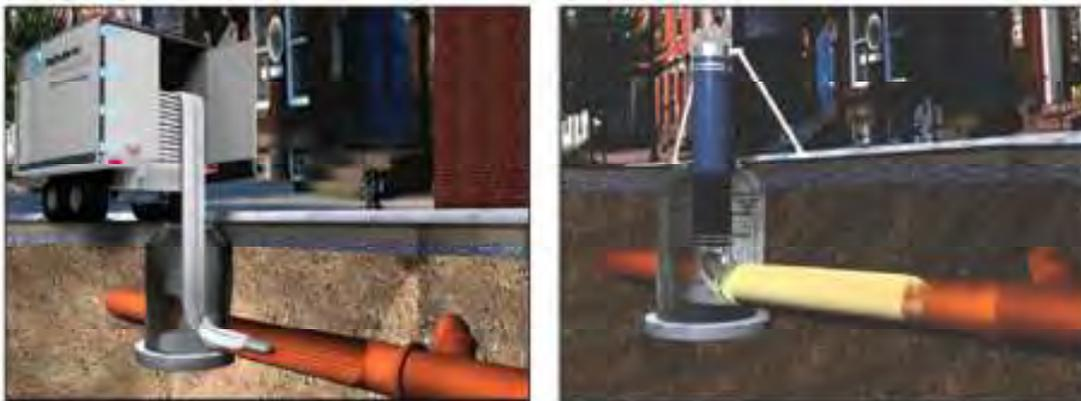
Figura 77: Opciones de instalación del revestimiento CIPP: empuje e inversión del revestimiento respectivamente
