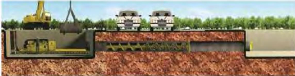
Figura 70: Esquema general de trazado y de excavación con tornillo sinfín.
