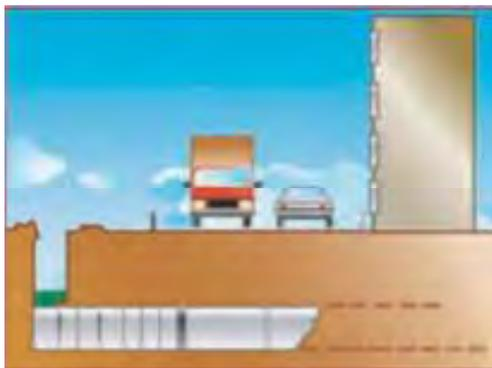
Figura 73: Esquema de cruce con Tunnel Liner
