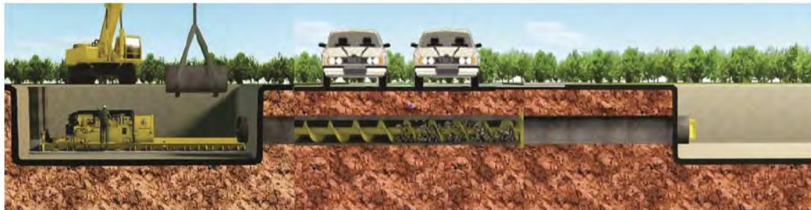
Figura 56: Esquema general de trazado y de excavación con tornillo sinfín.
