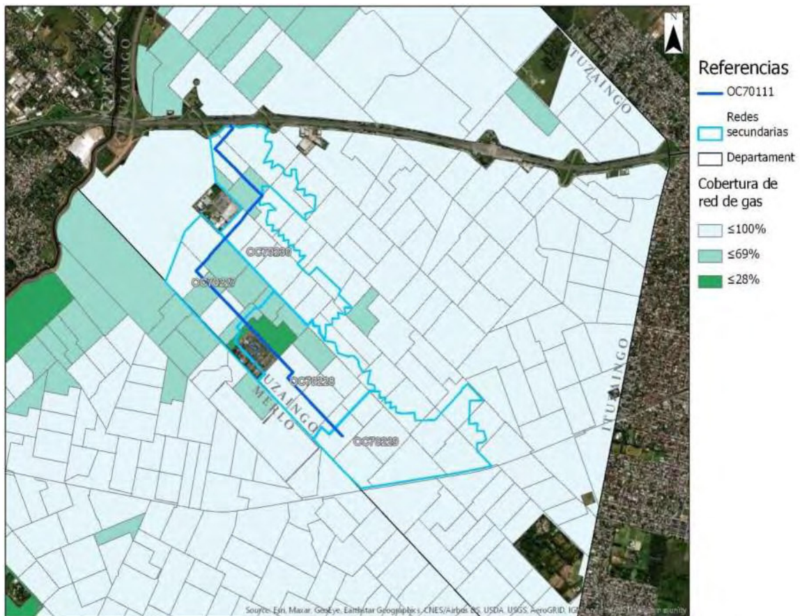
Figura 21: Cobertura de red de gas natural
